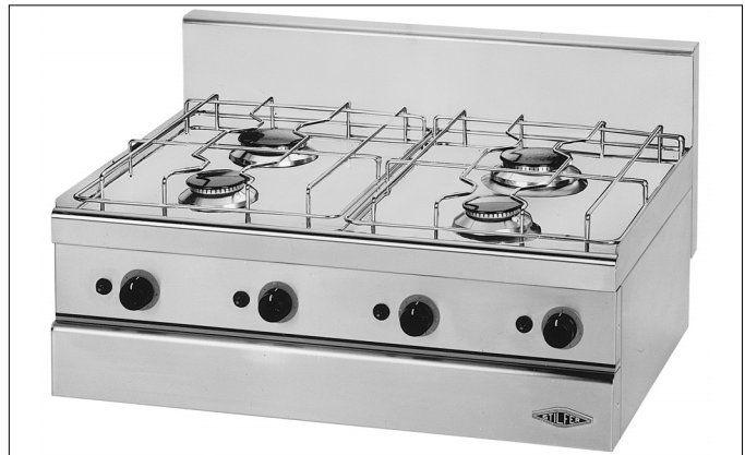
Kochfeld Gas KFN-254 G (SVGW-Zulassung Nr. 97-057-1) 2×2,2 kW/1'890 Kal. 2×3,5 kW/3'010 Kal. Gesamtleistung 11,4 kW/9'800 Kal. 2 Stellroste Inox. Art. Nr. 2491.003
