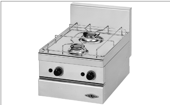
Kochfeld Gas KFN-154 G (SVGW-Zulassung Nr. 97-057-1) 2 Kochstellen 1×2,2 kW/1'890 Kal. 1×3,5 kW/3'010 Kal. Gesamtleistung 5,7 kW/4'900 Kal. 1 Stellrost Inox. Art. Nr. 2491.002
