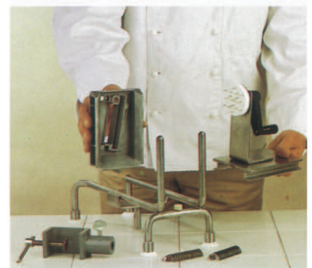
Für eine einfache Reinigung wegnehmbare Teile Parties amovibles pour un nettoyage facile
